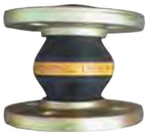
Tipo ERV a fascia gialla. Adatto per prodotti petroliferi e carburanti, metano (ma non per GPL). Adatto anche per emulsioni di acqua di raffreddamento con oli anticorrosivi. Temperatura di esercizio sino a 90°C.
