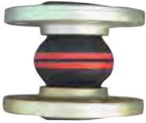
Tipo ERV ROTEX a doppia fascia rossa. Adatto per acqua calda di riscaldamento con temperatura di progetto sino a 110° C (con brevi punte a 130°C), per acqua di raffreddamento ed aria calda. Non idoneo per idrocarburi, per acqua potabile e per acqua ed aria con residui oleosi.
