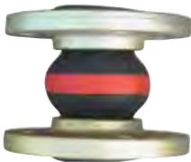
Tipo ERV a fascia rossa. Adatto per acqua potabile, acqua fredda e calda sino a 90°C, acqua marina, acqua di raffreddamento ed acqua di scarico priva di residui oleosi. Non idoneo per idrocarburi, per acqua ed aria con residui oleosi.
